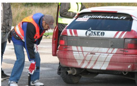
Hyvin näyttää sujuvan äänimittaus paljaan asfaltin päällä, lisäksi auton vieressä oikealla oli metrin päässä betoniseinä.
