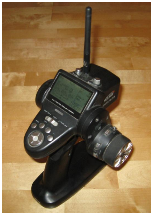
Radiolaitteita on tarjolla muutaman kympin radioista aina monen sadan euron huippumalleihin, kuvassa japanilaisen Futaban malliston huippua edustava 4PK 2,4 GHz 4-kanavainen radio. Ensimmäiseksi radioksi riittää hyvin n. 100 euron 2-kanavainen 2,4 GHz radio. Kaikista halvimmissa radioista puuttuu tärkeät EPA-säädöt, joilla saa rajoitettua sekä kääntyvyyttä että nopeutta ja jarruja.
