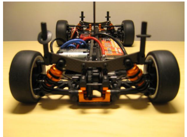
Painopiste on tuotu mahdollisimman alas ja ajovalmiiksi sähköistettynä hieman painorajan alle jäävää autoa voidaan hienosäätää lisäpainoilla sivu- ja pituussuunnassa.
