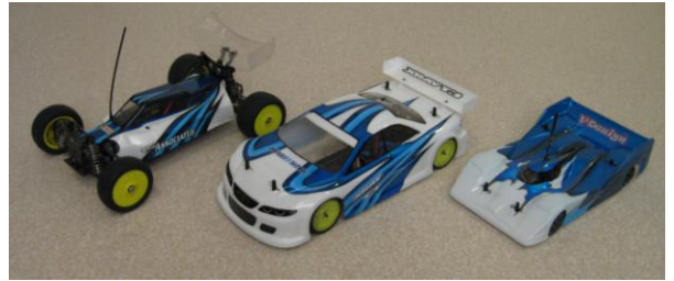
Kuvassa yhdysvaltalainen kardanivetoinen nelivetosähköcrossari Team Associated B44.1, slovakialainen hihnavetoinen nelivetosähkötouringauto Xray T3 2012 ja suomalainen takavetomattoauto V-Dezign Carpet Ripper V. Keskimmäisen auton 1:10 Mazda 6 -korin ulkomitat ovat (44cm*20cm*12cm) lähimpänä esikuvaansa mittasuhteiltaan.
